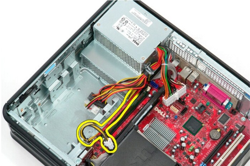
8. הסר את הברגים המחברים את ספק הכוח לגב מארז המחשב.
