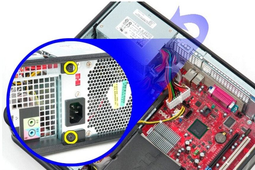
9. לחץ על תפס שחרור ספק הכוח בתחתית המארז ולאחר מכן החליק את ספק הכוח לכיוון חלקו הקדמי של המחשב.
