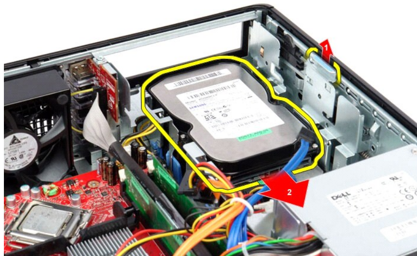
6. הרם את הכונן הקשיח והוצא אותו מהמחשב.
