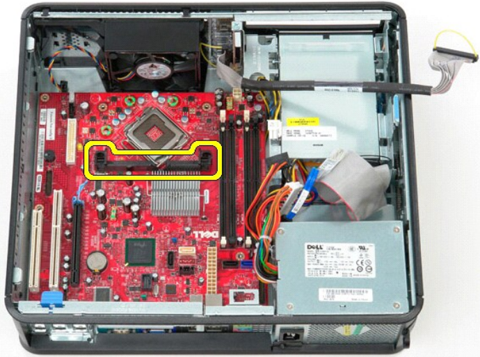
41. כדי להסיר את לוח המערכת, החלק את לוח המערכת לכיוון גב המחשב והרם אותו מעלה והוצאה מהמחשב.
